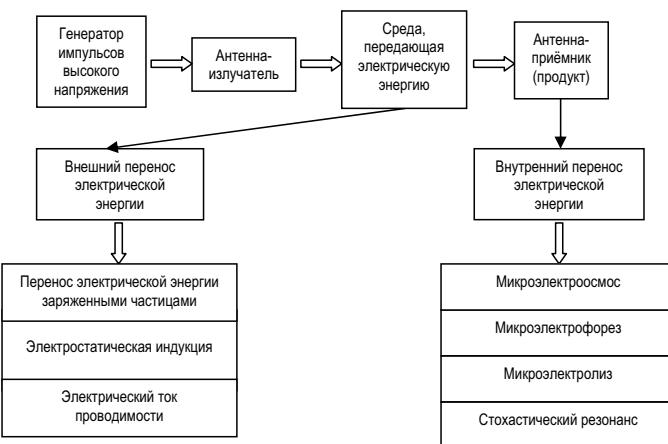
**Рис. 2. Физическая модель внешнего и внутреннего переноса электрической энергии в процессе сушки оболочки «Белкоzin» с использованием слабых электроимпульсных воздействий**
